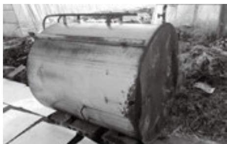
きちんと固定されていなかったため、地震で倒れてしまった貯油タンク
