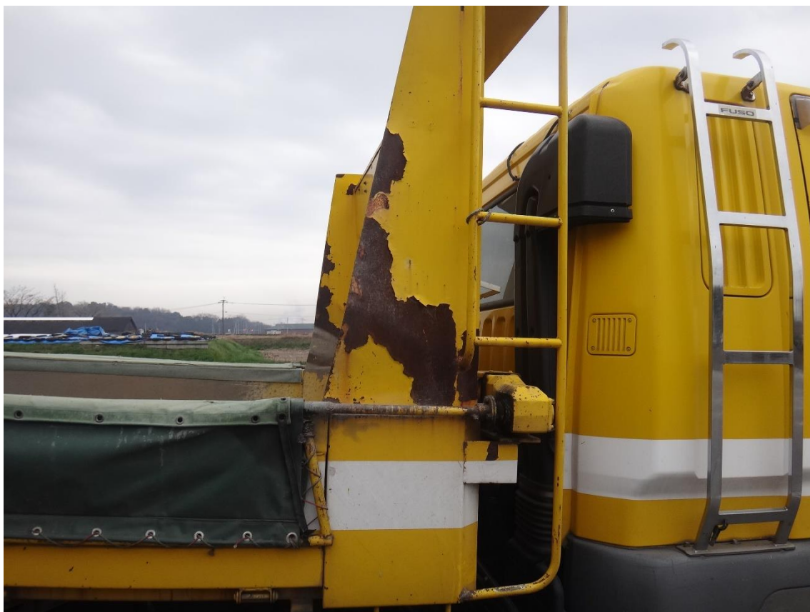
大きな損傷箇所⑤-1（右側ガードフレームの変形）
