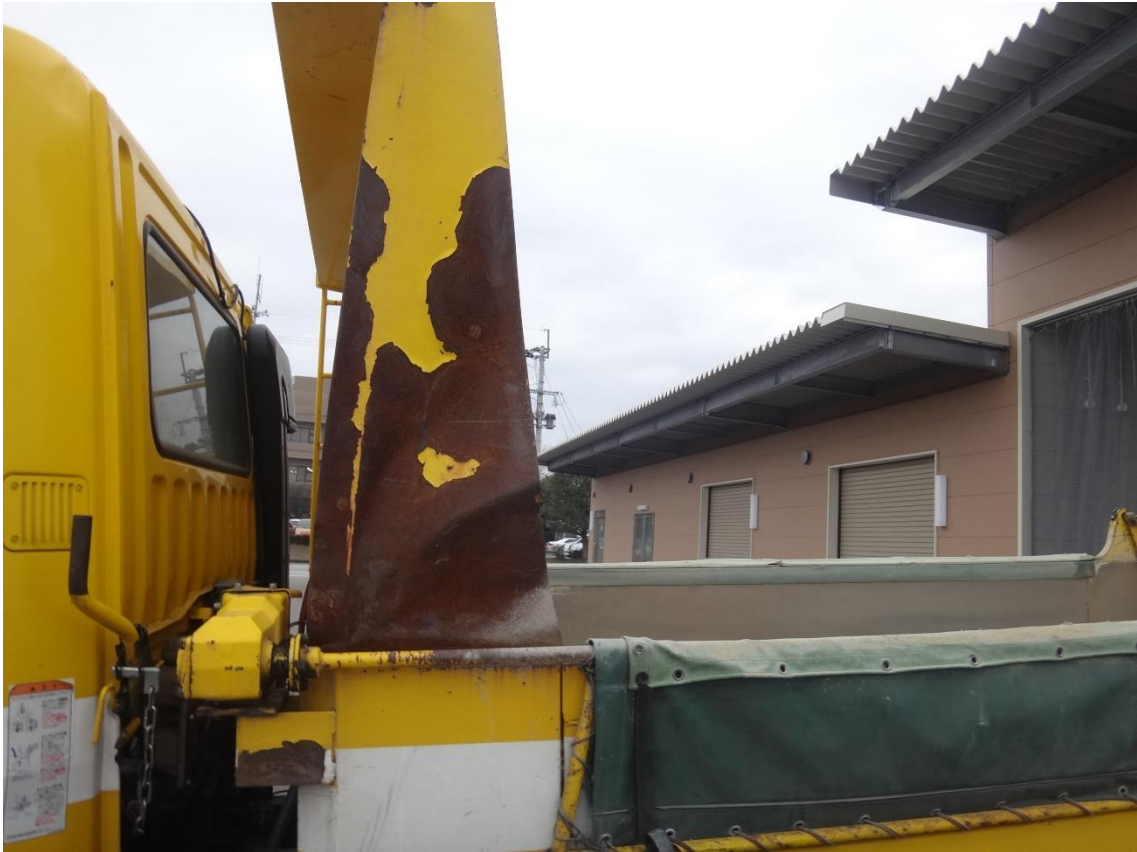
大きな損傷箇所⑤-2 (左側ガードフレームの変形)
