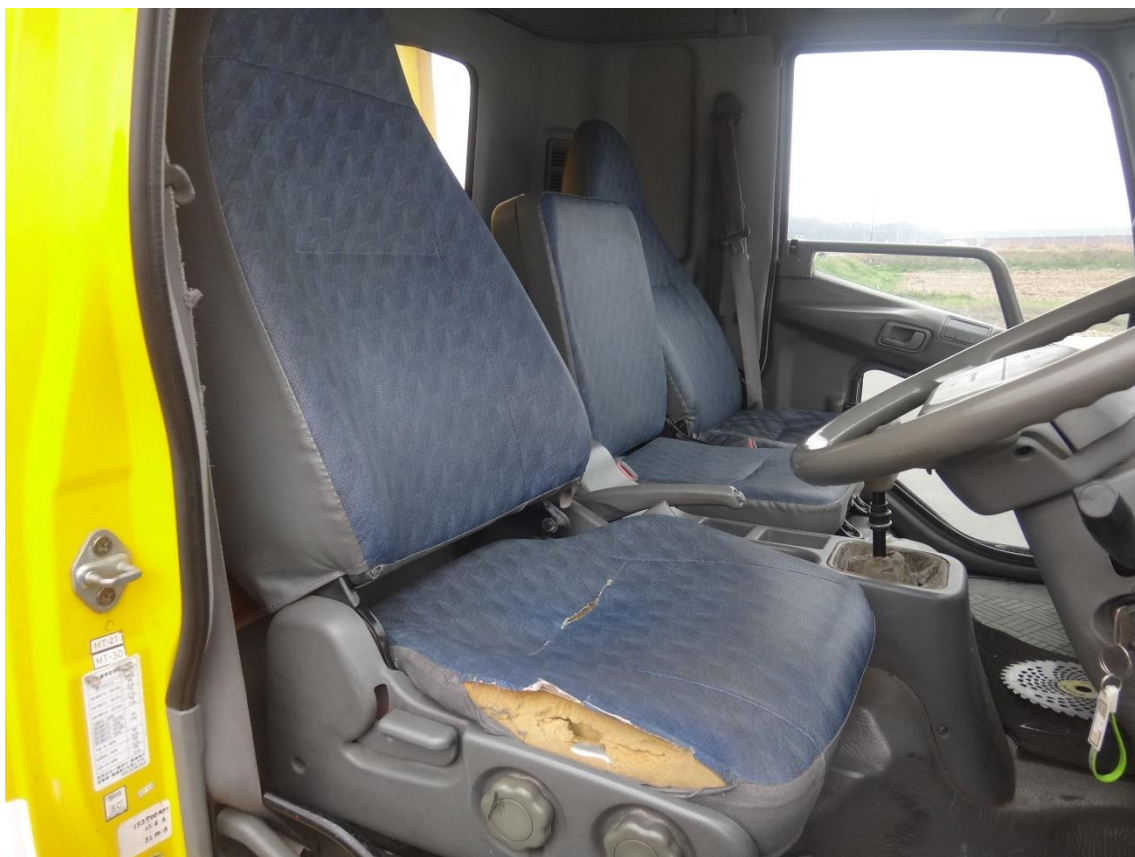
大きな損傷箇所③（運転席・助手席シートの破れ）
