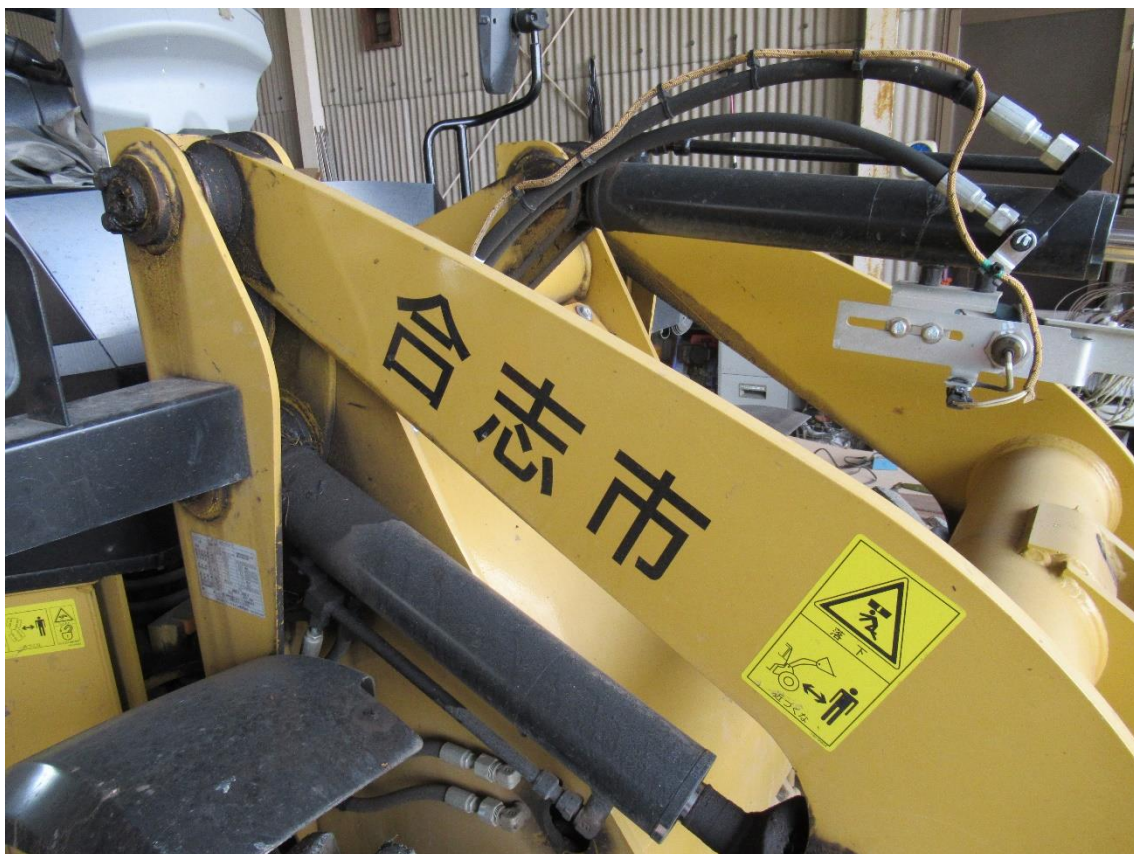
大きな損傷箇所（塗装の剥がれと錆び）
