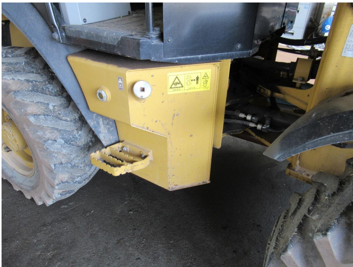
大きな損傷箇所（塗装の剥がれと錆び）
