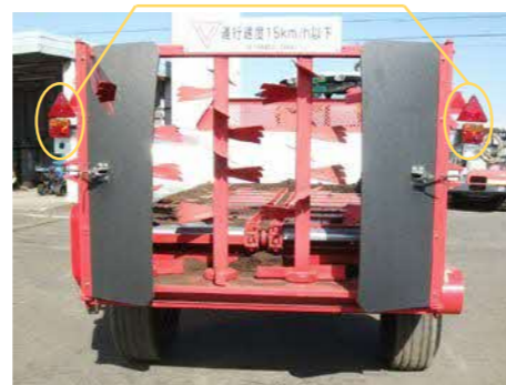
後部反射器及び灯火器類の設置例
