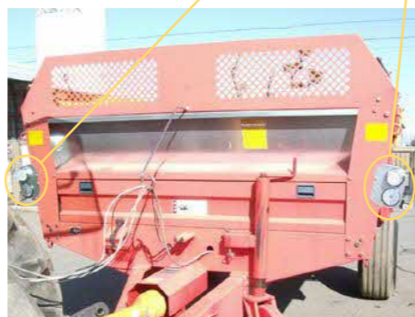
後部反射器及び灯火器類の設置例
