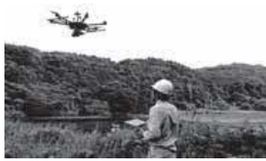
▲ドローン(UAV)による測量
