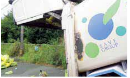
▲火災の被害を受けた収集車
