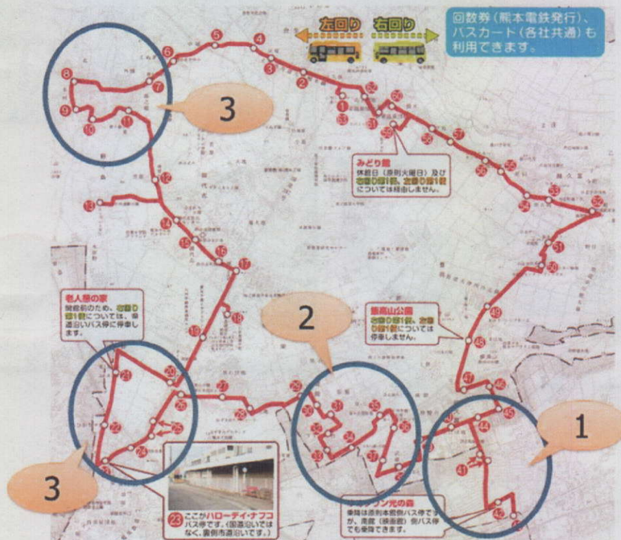
[図6]近接停留所の誤判定が発生しやすい場所
