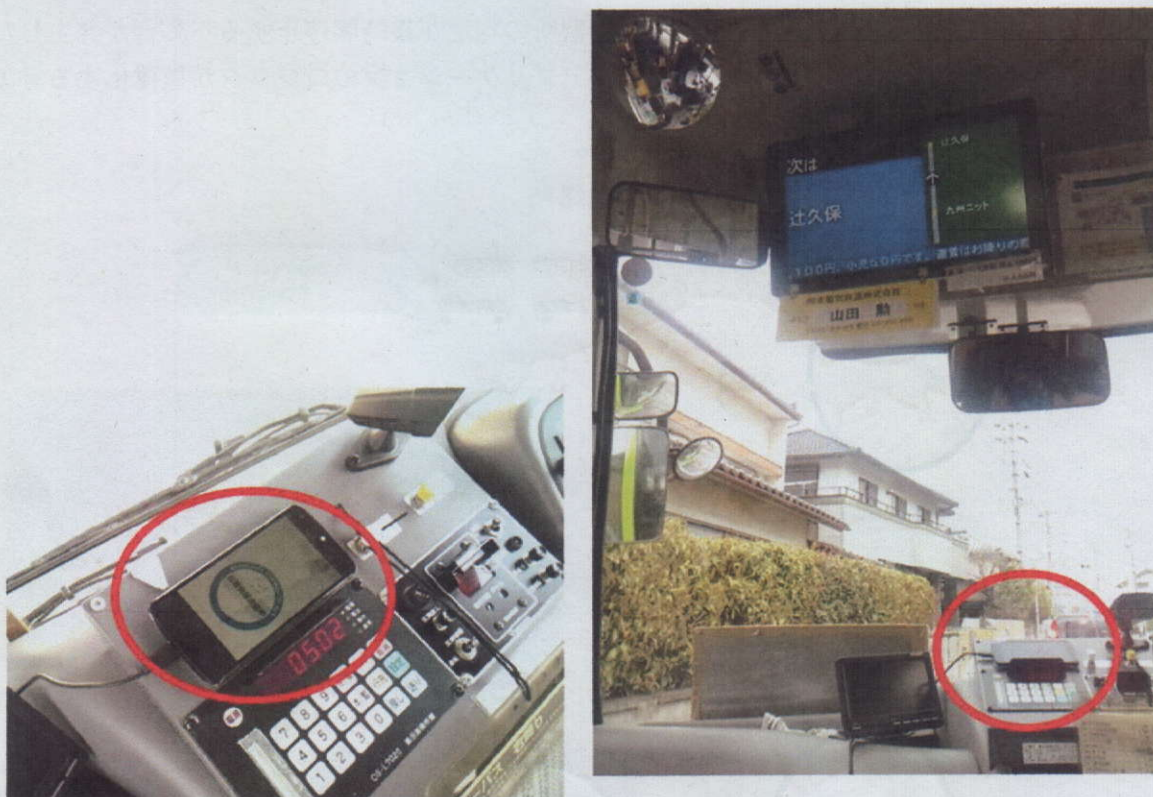
[図7] 車載端末の設置状況
